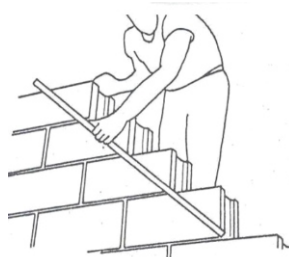
Verificaciones del nivel, plomo, desplazamiento y alineado de las unidades.
